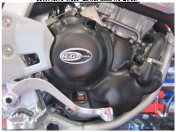
Le kit doit contenir: 1 x Protection carter moteur (ECC0160). 4 x Boulons M6x40mm.
